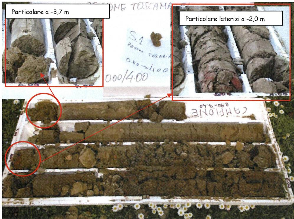
Foto della cassetta del sondaggio S1 da 0,0 a -4,0 m da pdc, con evidenziati due zoom, uno relativo ai frammenti di laterizi centimetrici ben visibili fino alla quota di 2,0 m e l'altra con evidenziata l'ingrandimento della carota intorno a 3,70 -3,9 m dove sono stati rinvenuti dei microframmenti di laterizi non percepibili in foto.
