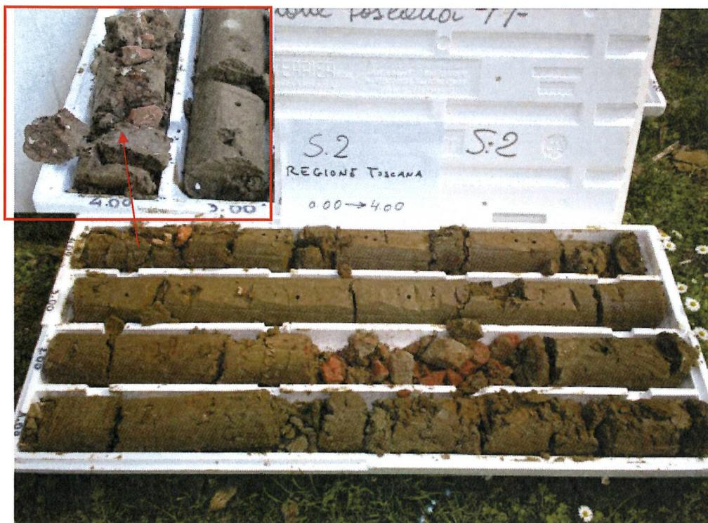
Foto della cassetta del sondaggio S2 da 0,0 a -4,0 m da pdc, con evidenziati lo zoom relativo ai frammenti di laterizi centimetrici ben visibili alla quota di 3,8 m da pdc.
