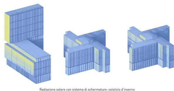
Radiazione solare con sistema di schermature: solstizio d'inverno
