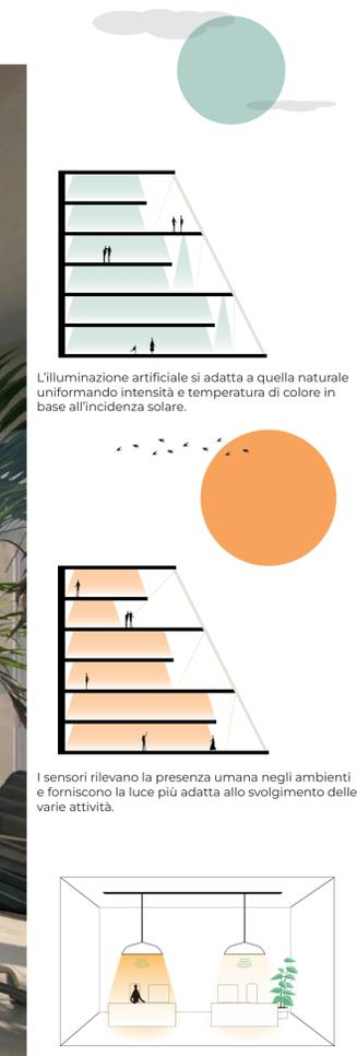
L'illuminazione artificiale si adatta a quella naturale uniformando intensità e temperatura di colore in base all'incidenza solare.
